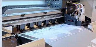
Вакуумная платформа и прижимные ролики из фторкаучука обеспечивают ровную подачу плёнки, без статики и смещений.
