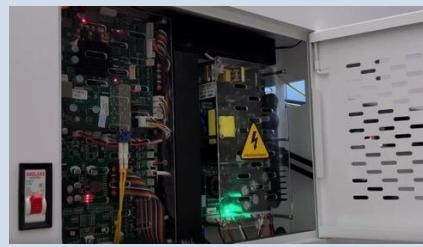
Интуитивный экран управления, промышленная плата Hoson, встроенные датчики температуры и влажности.
